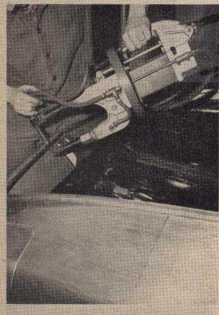
Fig. 23. — Soudage de la jupe AR sur tôle de gâche pour couvercle de malle.
