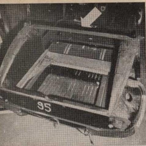
Fig. 3. — Mise en place des dispositifs de protection des organes de suspension hydraulique. La flèche indique la modification de la tablette AR destinée à recevoir la ceinture de dormant.
